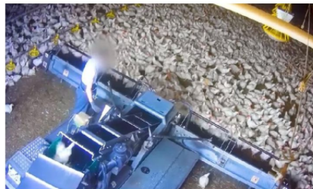
Une « moissonneuse à poulets » ramasse les animaux vivants pour les conditionner en cages.
